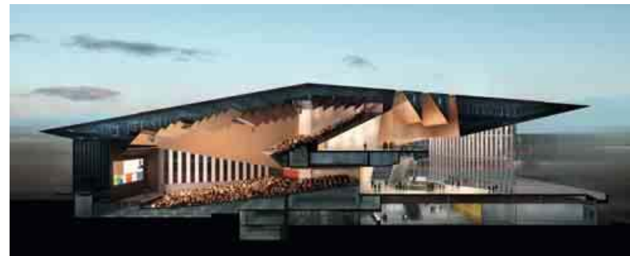
An dieser Darstellung wird deutlich wie sehr die Außenhülle des Gebäudes von der Raumaufteilung im Inneren bestimmt wird
